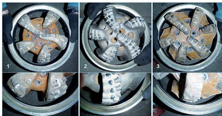
1. Потеря диаметра 22 мм 2. Потеря диаметра 15 мм 3. Потеря диаметра 18 мм
