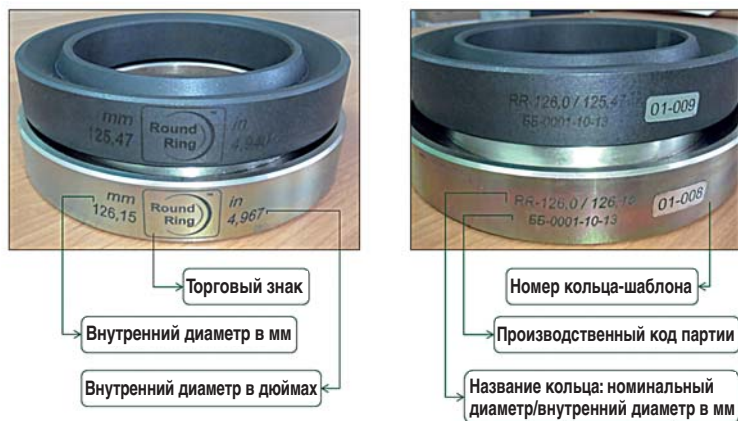
Рис. 6. Маркировка колец-шаблонов Round Ring™
